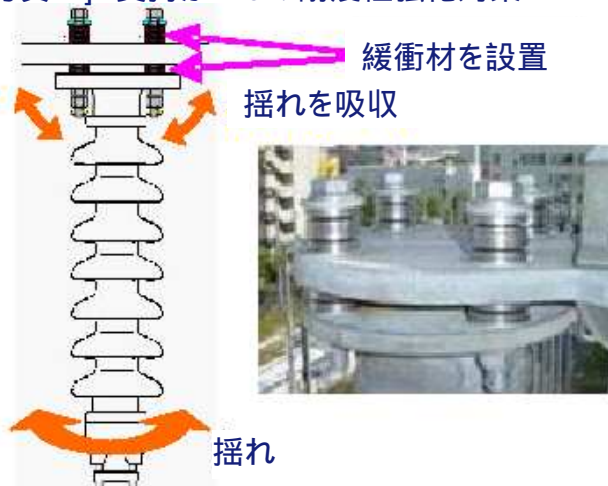
[写真] 支持がいしの耐震性強化対策
