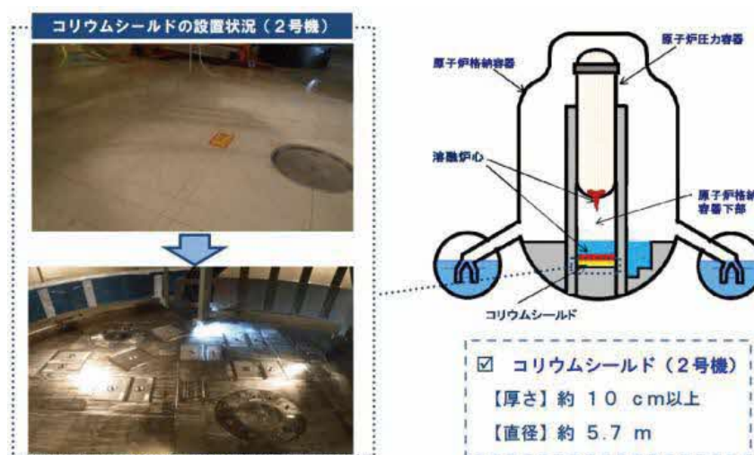
コリウムシールドの概念図
