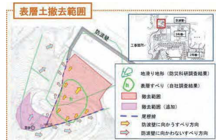
防波壁西端部の地山の表層土撤去範囲
