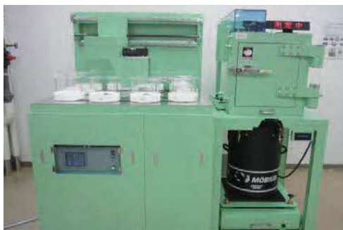
サンプルチェンジャー付ゲルマニウム半導体検出器
