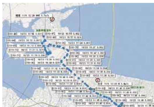
サーベイ車による走行サーベイ（例）
