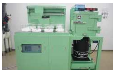
サンプルチェンジャー付ゲルマニウム半導体検出器
