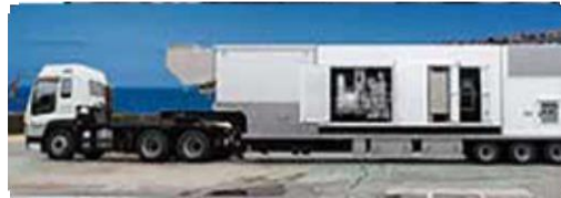
非常用炉心冷却系などを起動できる容量をもったガスタービン発電機車を配備
