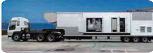
ガスタービン発電機車の配備
