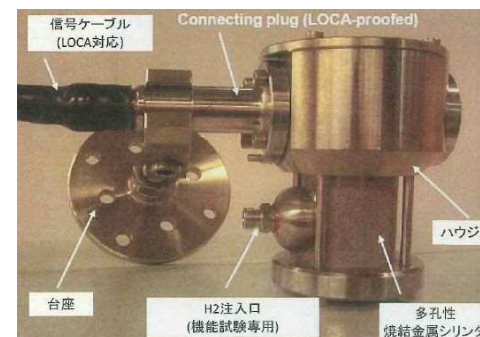
■ : 原子炉建物内水素濃度計
