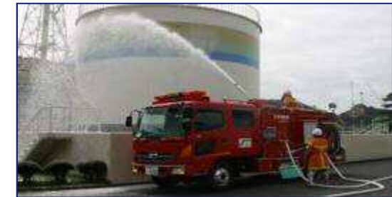
▲油火災にも対応できる化学消防車
