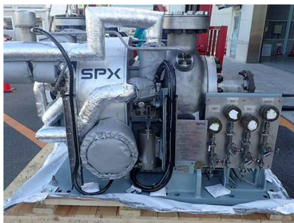
高压原子炉代替注水ポンプ
