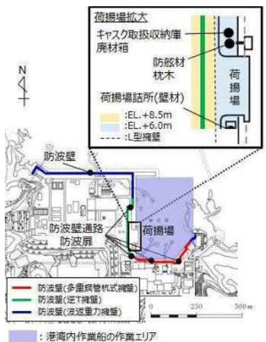
港湾内に面する津波防護施設に考慮する漂流物の配置
