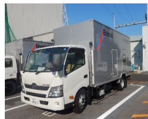
高圧発電機車
