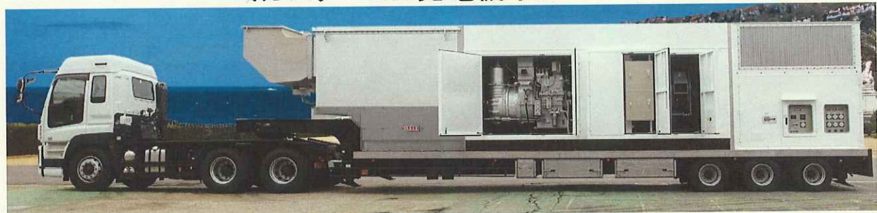
<ガスタービン発電機車>
