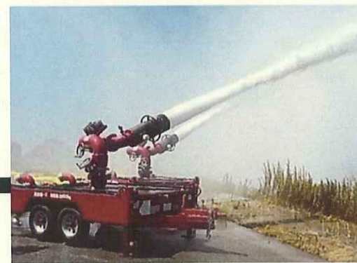
大容量泡放水砲システムによる放水訓練 (大阪・和歌山広域共同防災協議会)
