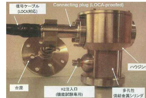
■ : 原子炉建物内水素濃度計
