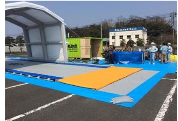
大型車両用除染テント等
