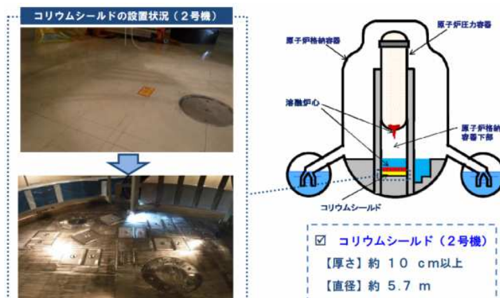
図5-27 コリウムシールドの概念図
