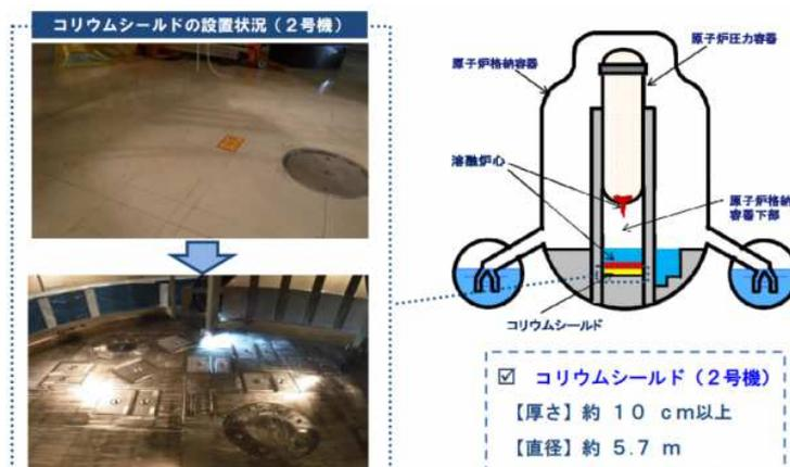
図5-27 コリウムシールドの概念図
