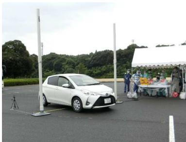
ゲート型モニタによる検査
