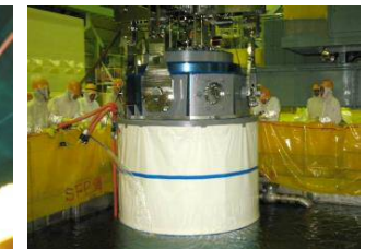
(写真3) 燃料プールから輸送容器吊り上げ
