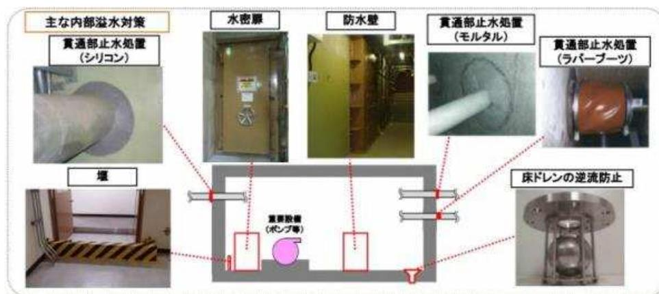
図5-15 溢水防護対策の例
