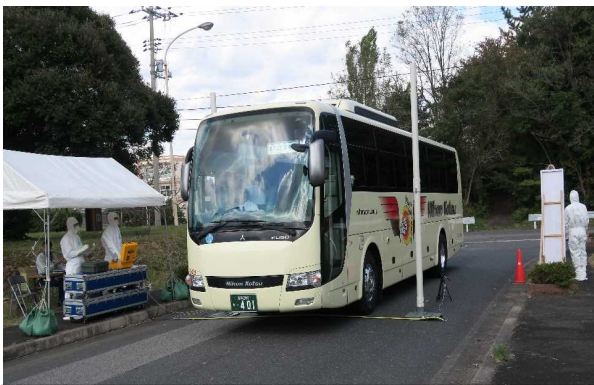
ゲートモニターによる指定箇所検査
