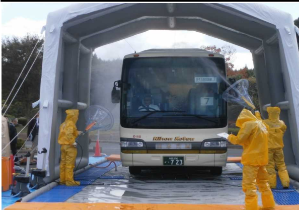
確認検査で基準値を超えた車両の除染
