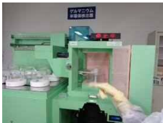
91_サンプルチェンジャー付ゲルマ検出器に 試料(砂、空気中の塵埃試料等)をセット
