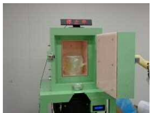
92_大型の水試料をゲルマ検出器にセット
