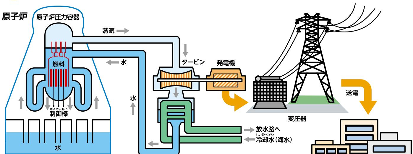
原子力発電所では、原子炉の中で燃料であるウランを核分裂させ、その時に発生する熱で水を沸騰させて蒸気をつくり、タービンを回して発電機により電気をつくります。
