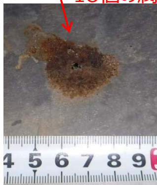
18個の腐食孔の一例
