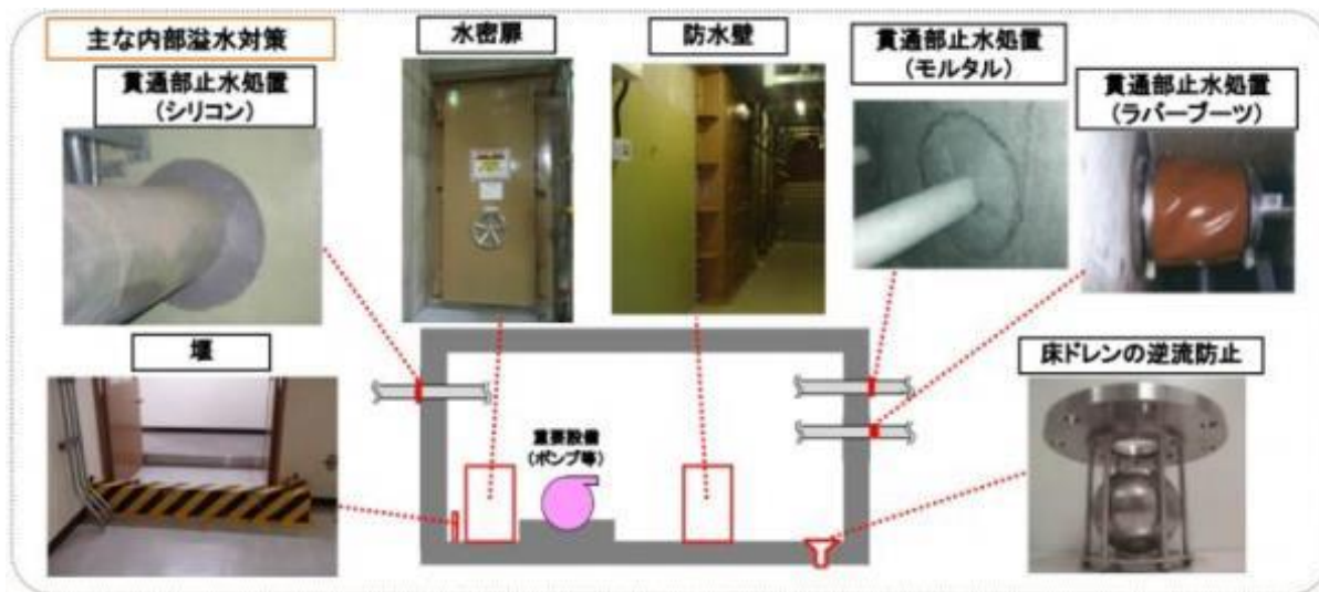
内部溢水対策の例
