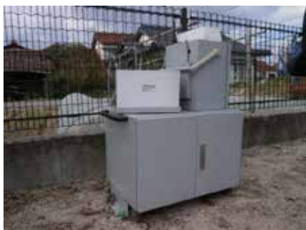
可搬型モニタリングポスト（交番設置）
