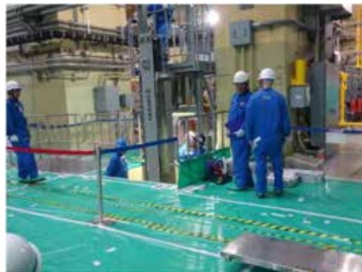
受入検査(燃料容器を立掛け台に固定)
