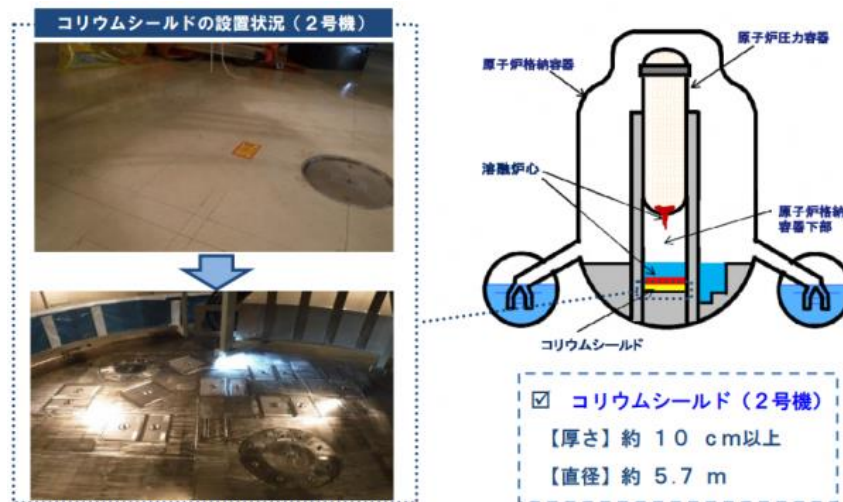
コリウムシールドの概念図
