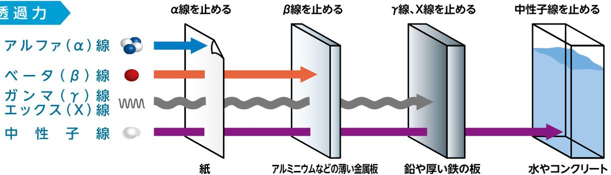
※アルファ線:ヘリウムの原子核 ベータ線:電荷を持った粒子 ガンマ線・エックス線:電磁波 中性子線:電荷を持たない粒子(中性子)
