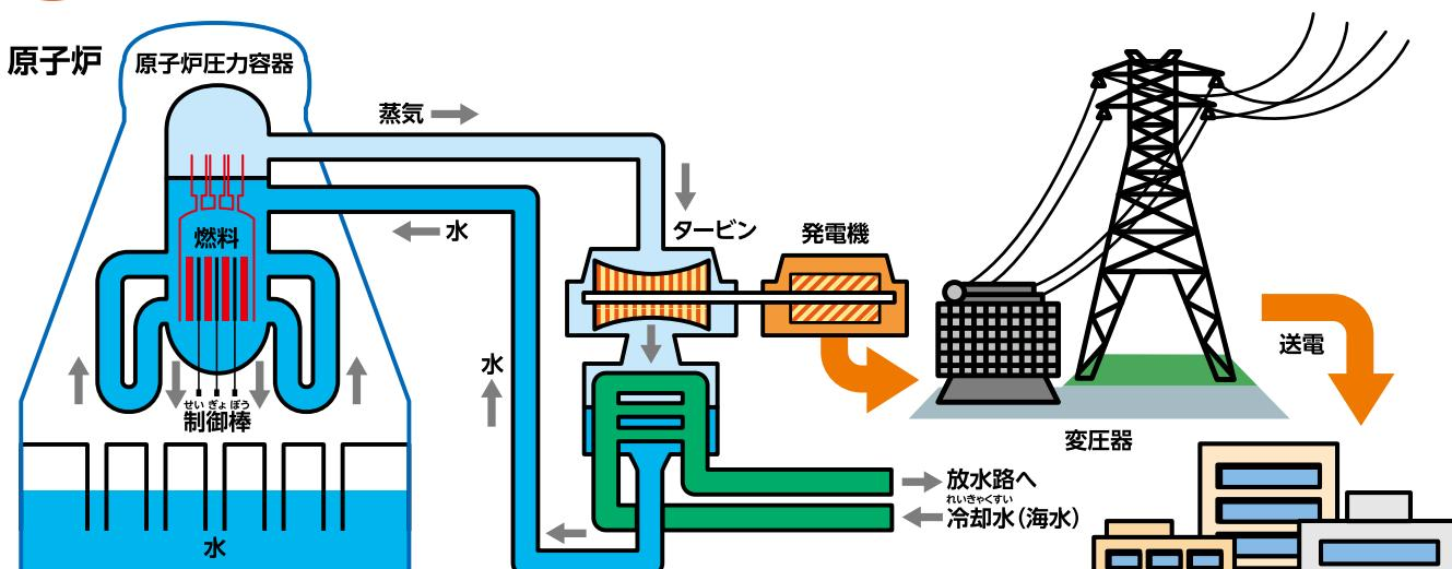
原子力発電所では、原子炉の中で燃料であるウランを核分裂させ、その時に発生する熱で水を沸騰させて蒸気をつくり、タービンを回して発電機により電気をつくります。
